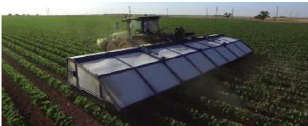
**Figura 10.** Pulverización selectiva mediante visión e inteligencia artificial (Blue River Technology-Deere & Co, EEUU).
