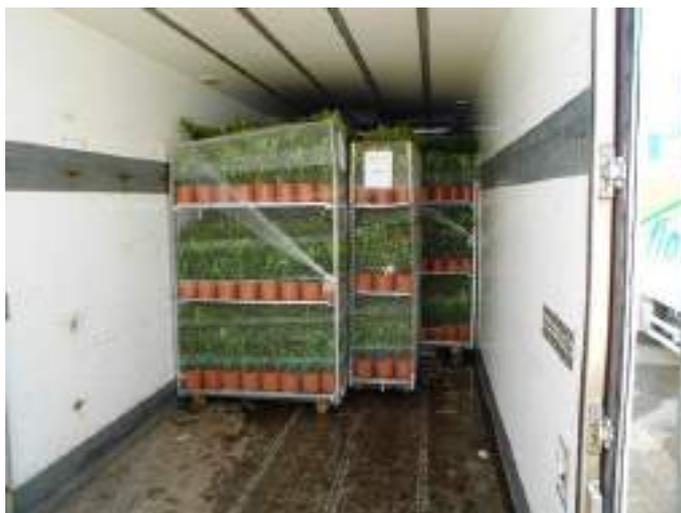
**Figura 15.** Camión cargándose con el sistema de carros CC
