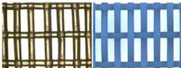
**Figura 10.** Imágenes microscópicas de las mallas relacionadas con los histogramas de frecuencias representados en la Figura 9. Malla con baja uniformidad (izqda.) y malla muy uniforme (dcha.)
