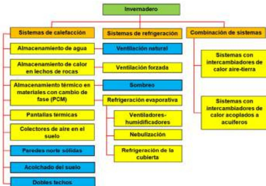
**Figura 22.** Clasificación de diversos sistemas de control climático para invernaderos (adaptado de Sethi y Sharma, 2008), destacando los métodos pasivos (■)
