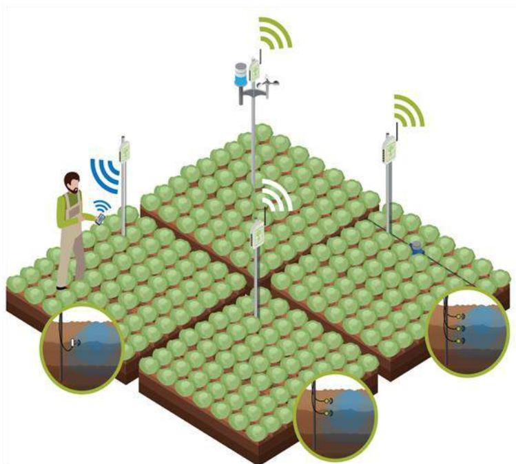
Figura 1. Esquema de una Red Inalámbrica de Sensores (RIS). Fuente: [www.safsampling.com](http://www.safsampling.com)
