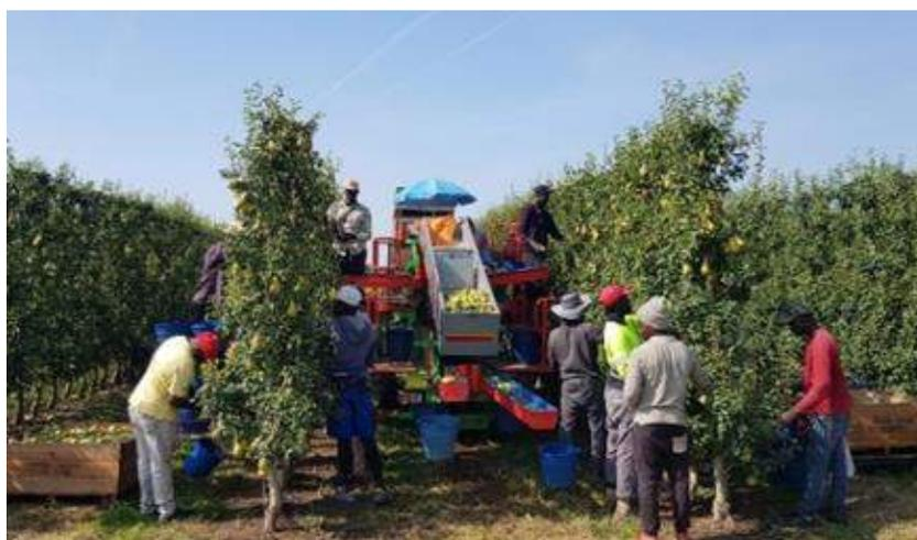
Figura 14. Plataforma colectiva autopropulsada
