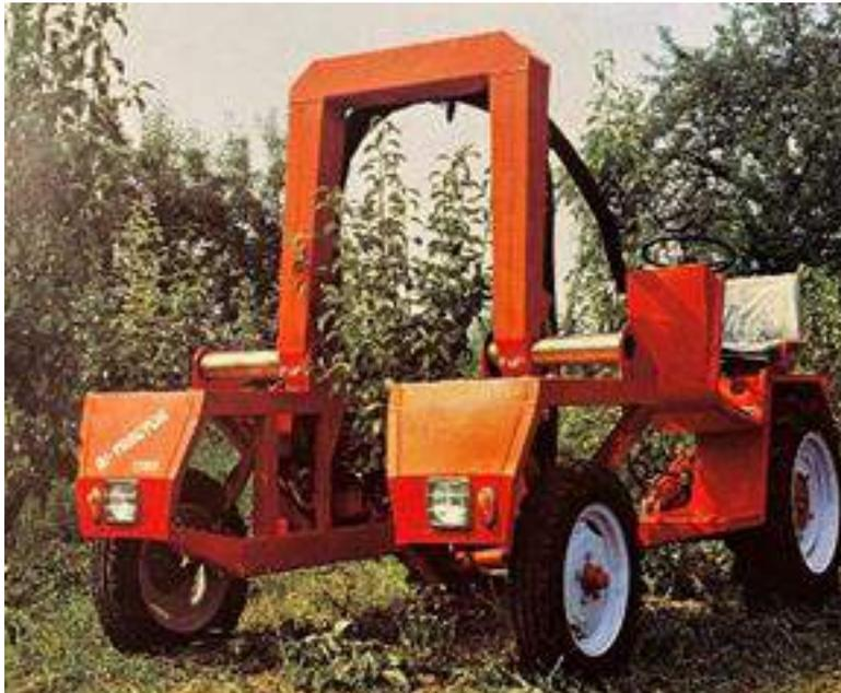
Figura 2. Tractor de ancho extensible y altura libre. BI-Tractor TBI
