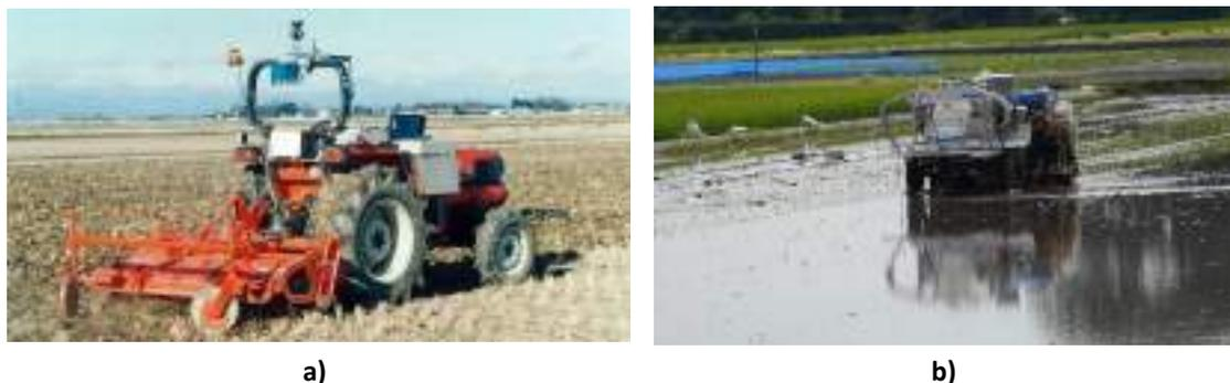
**Figura 8.** Automatización de laboreo y trasplante: a) Fresado con tractor robotizado Robotra (1997); b) Trasplantadora de arroz autónoma (NARO, Tsukuba, 2014)
