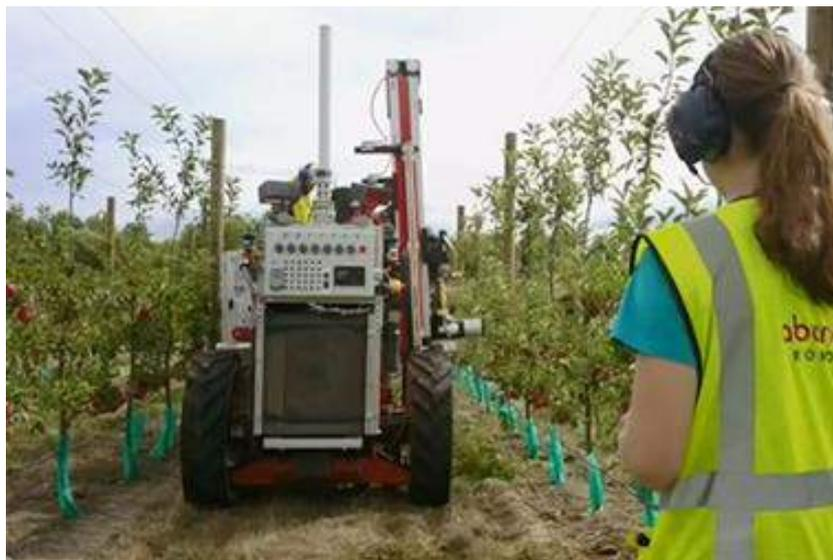
Figura 16. Cosechadora-robot para frutales en superintensivo
