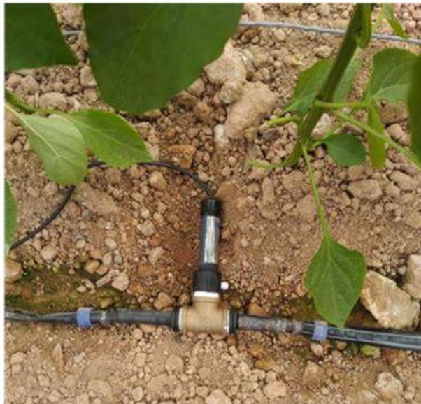
**Figura 13.** Detalle de un sensor de conductividad eléctrica del agua de riego (ES-2 METER Group) y de los datos de un evento de riego
