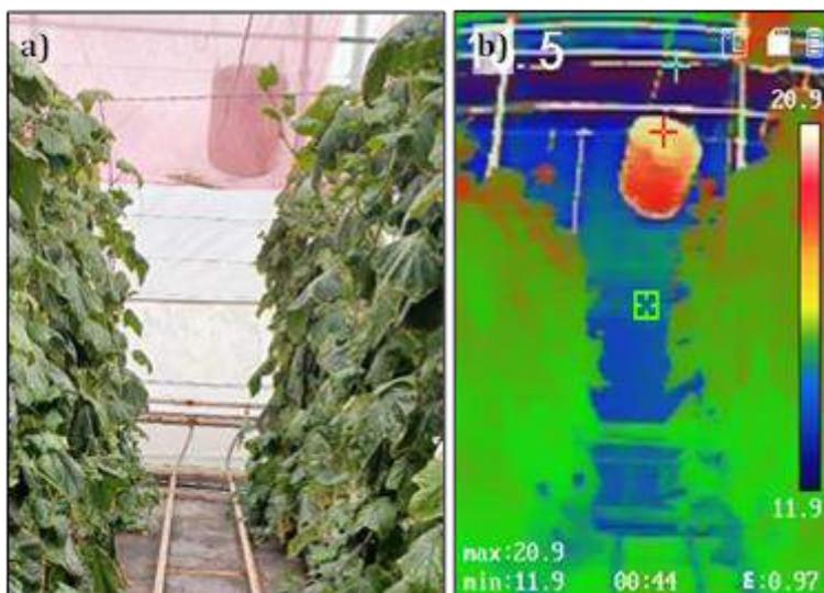
**Figura 4.** Imagen real (a) y termografía (b) de plantas de pepino en un invernadero multitúnel de Almería en el periodo invernal (10/12/2021)
