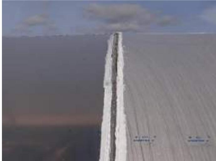
**Figura 4.** Vista de un plástico con efecto antigoteo (izquierda) frente a un testigo (derecha). El aditivo antigoteo hace que el vapor de agua condense en forma de una película continua en vez de formar gotas, lo que mejora considerablemente la transmisividad de la cubierta a la radiación
