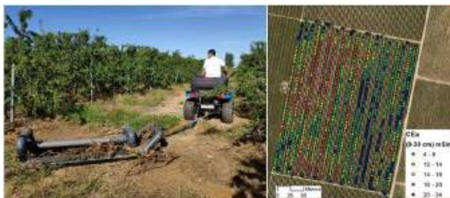
**Figura 7.** Cartografía de la CEa en una plantación súper intensiva de almendros de 6,5 ha localizada en Raimat (Lleida), mediante el sensor Dualem-2 (empresa Agrarium, Monzón, Huesca). La imagen de la derecha muestra los puntos de muestreo adquiridos coloreados según el valor de la CEa superficial. Fuente: izquierda, foto José A. Martínez; derecha, elaboración propia a partir de datos adquiridos en el proyecto PAgFRUIT (RTI2018-094222-B-I00)
