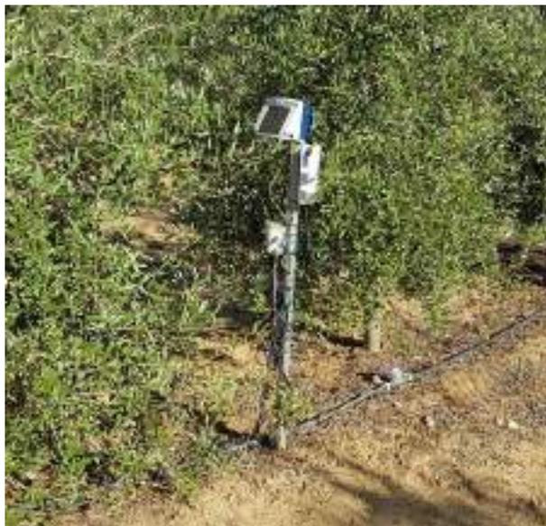
**Figura 14.** Datalogger alimentada por una pequeña placa solar para sonda de humedad instalada en cultivo de olivar intensivo
