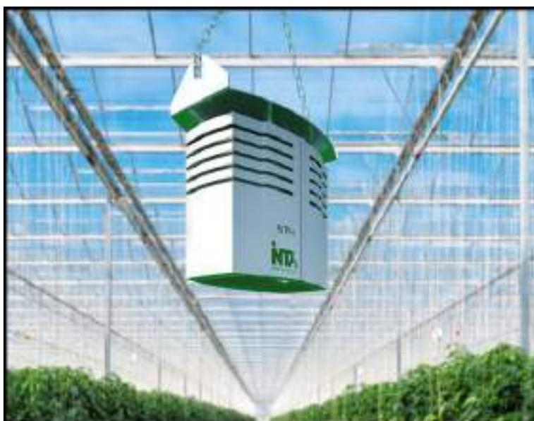
**Figura 28.** Sonda de temperatura y humedad electrónica, con ventilación forzada
