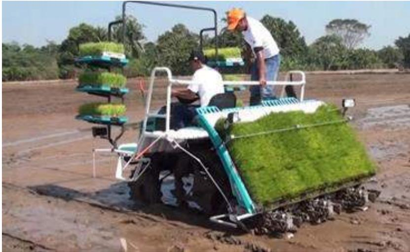
**Figura 3.** Trasmplantadora automática para arroz
