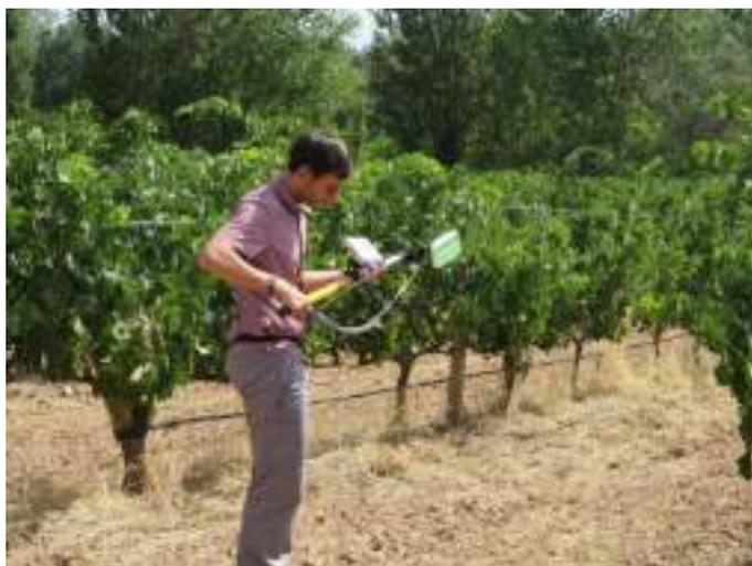
**Figura 12.** Equipo de medida de reflectancia (caracterización estrés hídrico)
