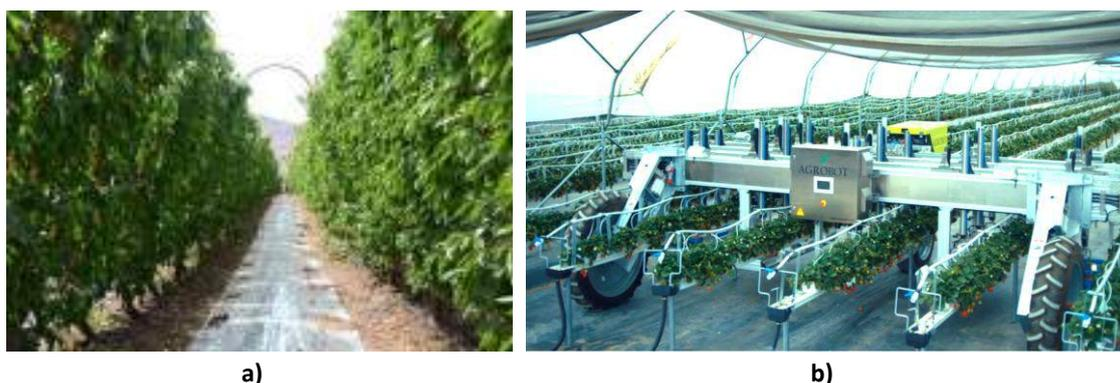
**Figura 14.** Robotización para la recolección de frutas: a) Acondicionamiento del cultivo de cerezas en espaldera (EEUU); b) Robot para recoger fresas (Agrobot, España).
