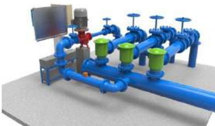
**Figura 17.** Fotografía y render de la Planta Piloto de recuperación de energía hidráulica mediante PAT en una instalación de riego en la provincia de Córdoba
