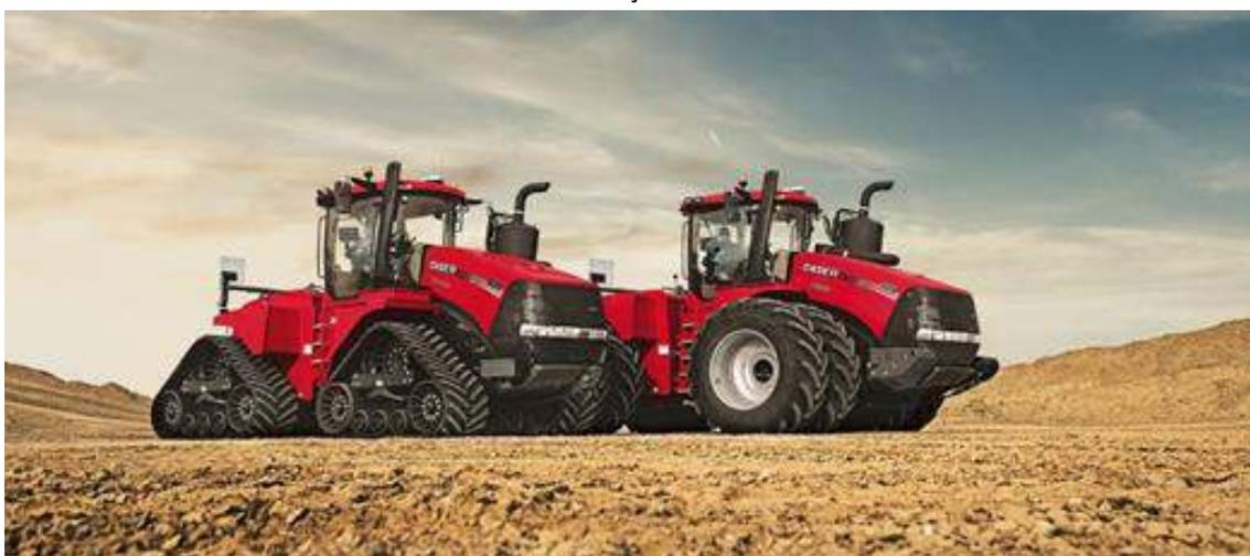
**Figura 1.** Tractor CASE IH Quadtrac 620. (514 kW y 24 t de peso)
