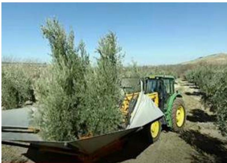
**Figura 12.** Vibrador de tronco con “paraguas”
