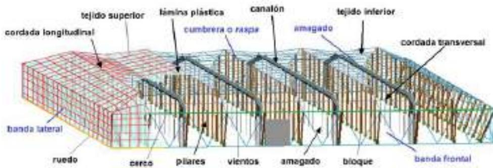
**Figura 13.** Invernadero sencillo de tipo Almería con estructura en «raspa y amagado»
