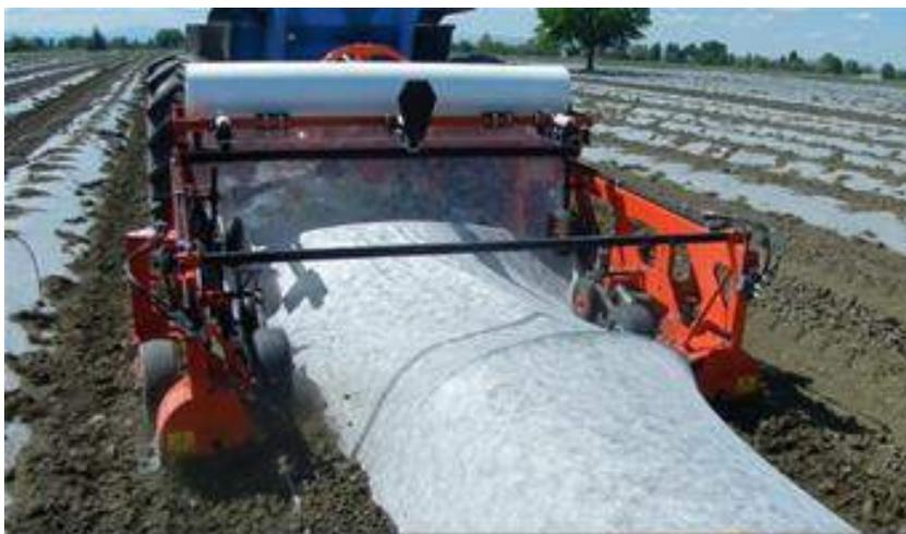
**Figura 4.** Extendidora de película sobre arquillos
